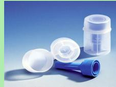
**ParaTEST VET** es un sistema de concentración de parásitos intestinales por el método de flotación.
